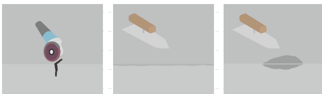
亀裂部Uカットシール処理
